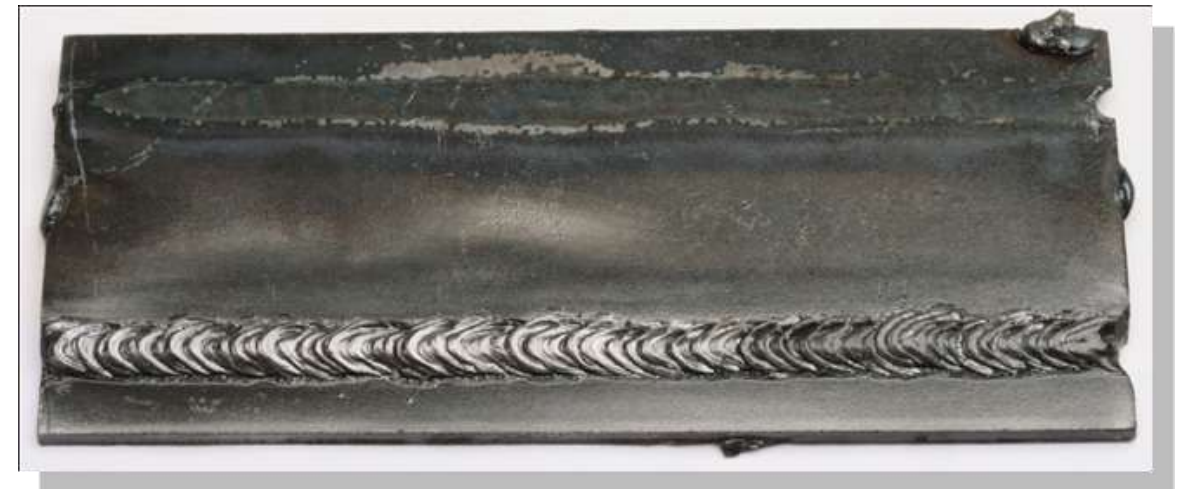
نمای خط جوش پس از انجماد بر روی قطعه کار فلزی
