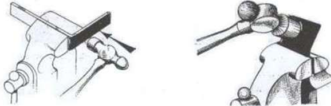
نمونه هایی از روش خمکاری با چکش و فکهای گیره
