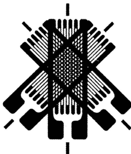
شکل ۷-۷ چهارپره کرنشسنج برای اندازه گیری پیچش
